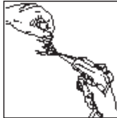
Puhdista suodatin puhaltamalla sille paineilmalla.
