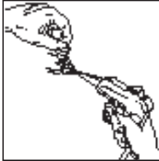
Filtrą išvalykite suslėgto oro pūstuvu.
